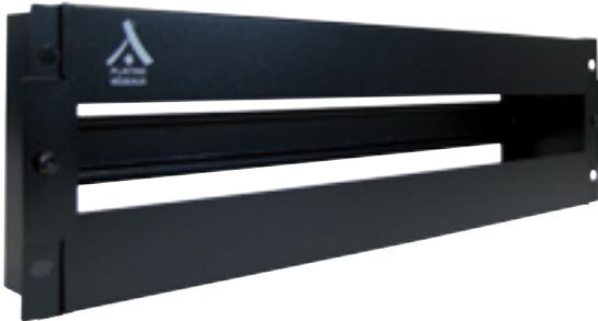
Bandeau 3U décaissé avec rail DIN pouvant accueillir jusqu'à 24 modules. Le tout est fourni avec la visserie nécessaire à la pose dans un coffret ou une baie 19 pouces. Matériau : acier laminé à froid d'épaisseur 1,2mm. Couleur : noire.
